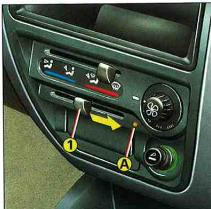
**Hvis varmeapparatet ikke virker**, kontroller drivstoffnivået og slå på varmeapparatet på nytt.
