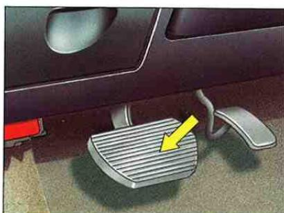
De kan selvfølgelig bremse på normal måte med bremsepedalen. Bremsesystemet er utstyrt med en bremseforsterker.
