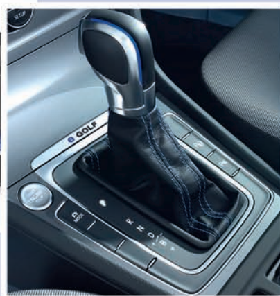
Селектор с синим швом чехла и дополнительным положением «В»
