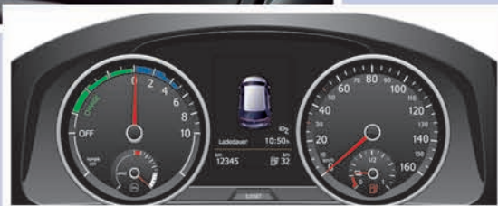
Комбинация приборов с указателями для электропривода
