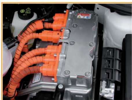
Электроника управления электроприводом и силовыми цепями электропривода JX1
