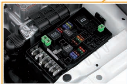
Коммутационный блок с блоком реле и предохранителей SB и блоком предохранителей Multifuse SA в моторном отсеке рядом с блоком электроники управления электроприводом и силовыми цепями электропривода JX1
